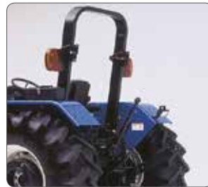
Şekil 14: Devrilmeye karşı koruma sistemli (Roll-bar) bir traktör
